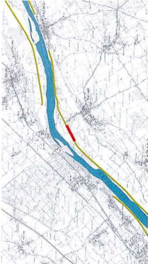
Tracé des levées à l'amont de Blois - En rouge : le déversoir de Montlivault (GEOSCOP 2012)
