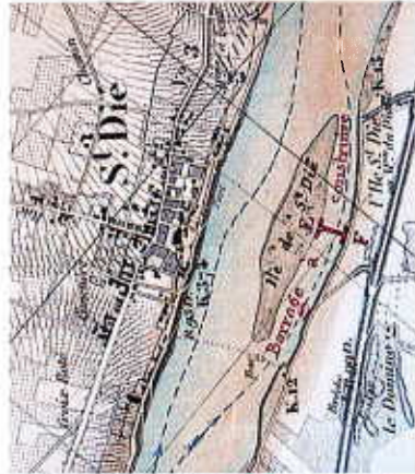
La carte de l'ingénieur Coumes (1848) montre les aménagements réalisés dans la première moitié du 19 e (perré et cales). Le projet de barrage du bras nord de la Loire (en rouge) n'a pas été réalisé. (source : Région Centre – Inventaire régional)
