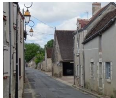
Alignement avec alternance de murs pignons et de murs gouttereaux.
